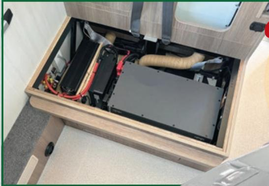
**412Ah 固体リチウムバッテリー**
